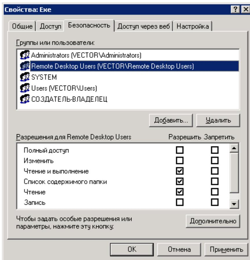
Рисунок 8.2 - Назначение прав доступа к файловой системе. Действие 2
